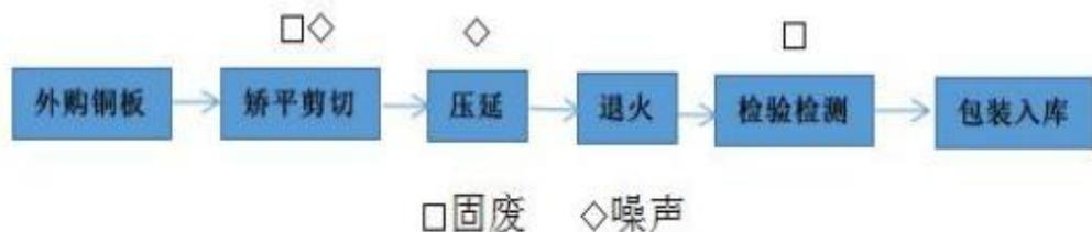
图 2-3 原有项目生产工艺流程及产污环节图
