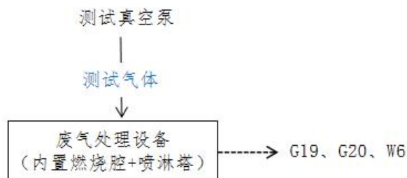
图 2-6 本项目废气处理设备研发测试实验工艺流程及产污节点图
